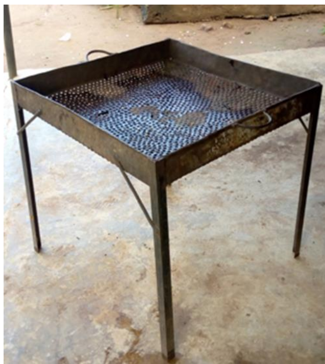
Photo 3 : Tamis permettant de séparer le souchet de la terre à la récolte
