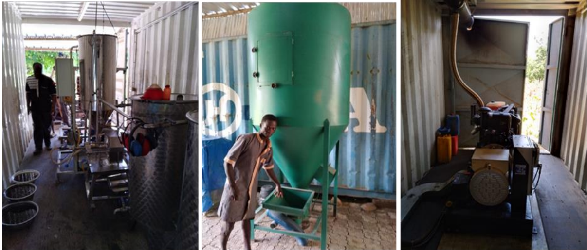
Photo 2: 1. Unité de presse d'huile; 2. Mélangeur pour la production de tourteau de tournesol; 3. Groupe électrogène fonctionnant à l'aide d'huile brute de tournesol comme biocarburant (Poko Sarl)
