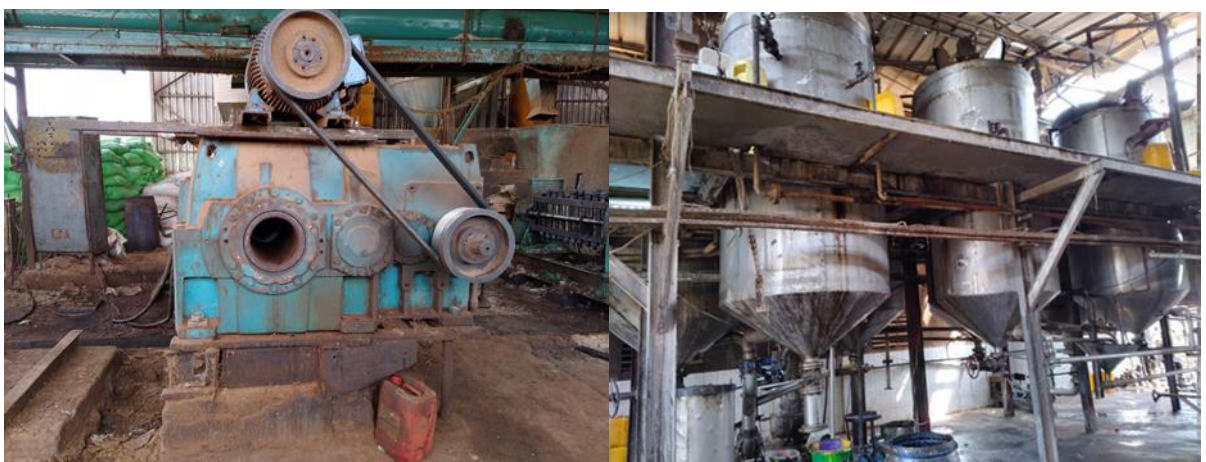
Photo 3: A. presse à huile, B. plateforme d'extraction et de raffinage de l'huile chez GENOL
